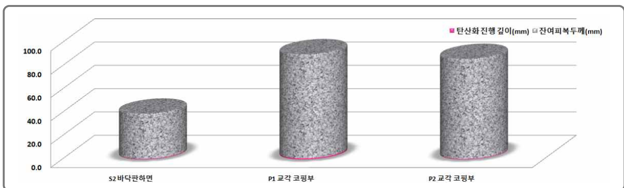
[그림 4.2.3] 탄산화깊이 및 잔여피복두께 측정결과
